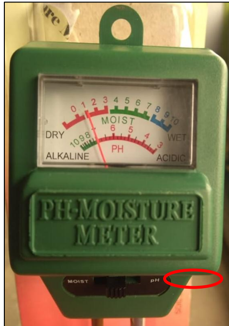
Ilustración 7: Configuración del equipo Brixco para medir pH Fuente: Autores, 2019
