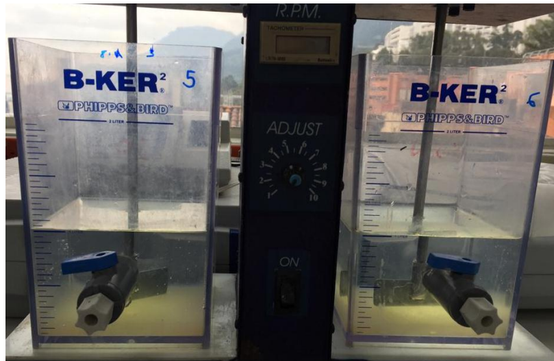
Ilustración 23. Resultado prueba de coagulación por barrido.
