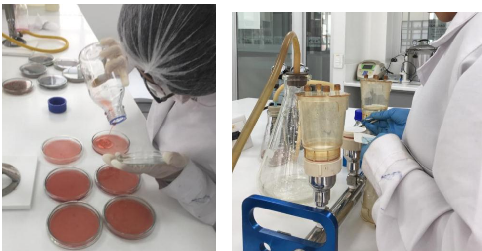
Ilustración 9. Preparación de medios y ensayo tren de filtración. Fuente: Autores.
